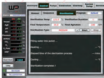
一触式罐体管道系统自动灭菌
