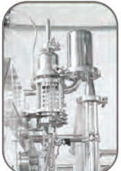
机械密封润滑 自动冷却装置
